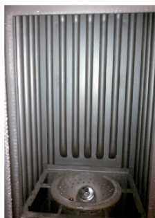
Cámara de combustión con intercambiadores verticales y brasero en fundición por floración (Helsinki Max 34)
